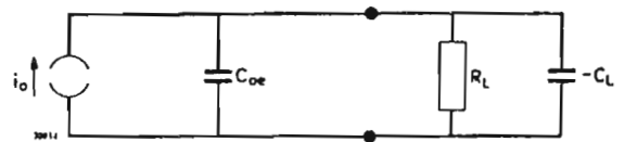
Fig. 10 - Circuito equivalente di uscita di un transistor con la sua ammettenza di carico.
